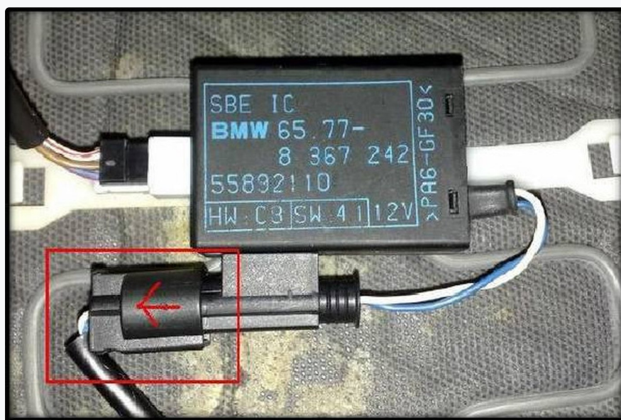
SBE-STEUERGERÄT UNTER DEM BEIFAHRERSITZ
