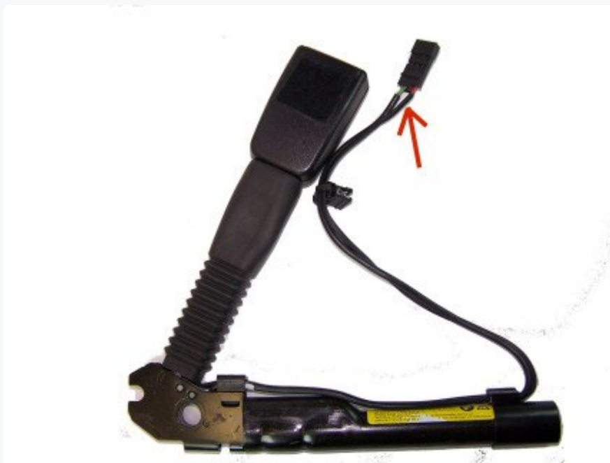
CAVO DI ALIMENTAZIONE SULLA FIBBIA DELLA CINTURA
