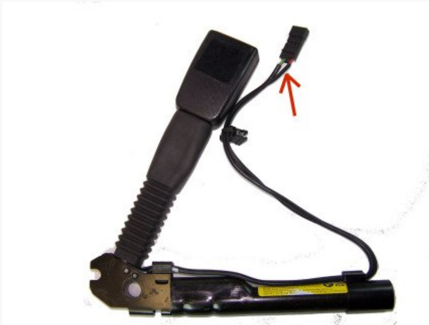
ZULEITUNG AM GURTSCHLOSS
